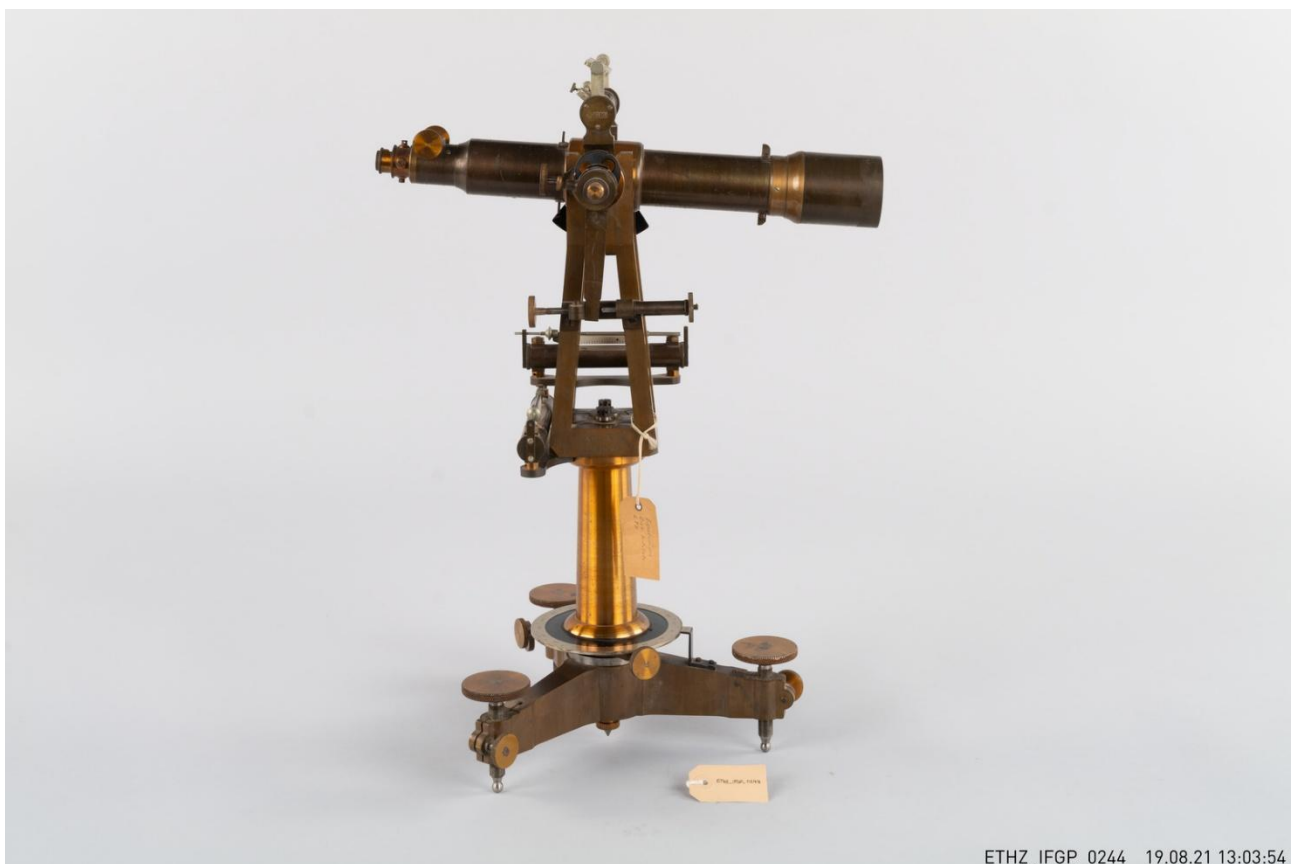
Abb. 11: Passage-Instrument Modell Kern, Nr. 18642 (ETH Zürich, IGP 2021)
