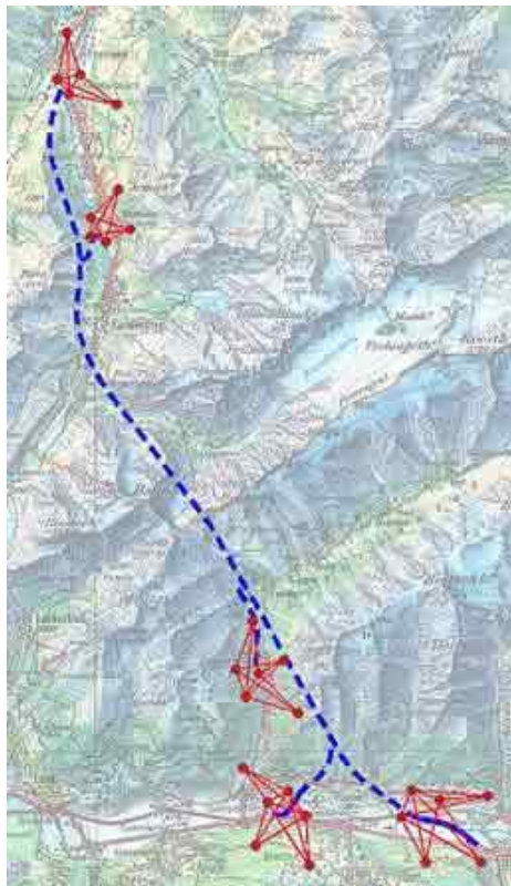
Abb. 4-1: Grundsätzliches Konzept der Grundlagenvermessung: Kombinierte, mit GPS und terrestrischen Methoden gemessene Portalnetze und lokale Höhenanschlüsse an das Landesnivellement. Auf ein übergreifendes Triangulationsnetz für die Richtungsübertragung und die Verknüpfung der Portalnetze wurde verzichtet (vgl. auch Abb. 4-2).
