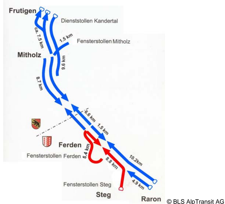
Abb. 2-2: Vortriebskonzept und Längen der Tunnelabschnitte
