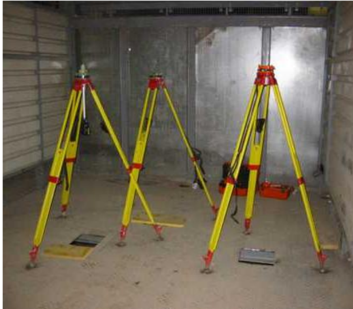
Schachtkopf: Stative in der Liftkabine
